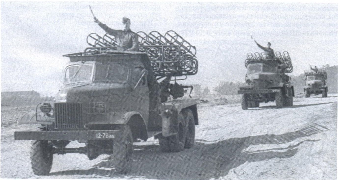
Боевые машины БМ-24 на марше. Хорошо видны "сотовые" направляющие реактивных снарядов
